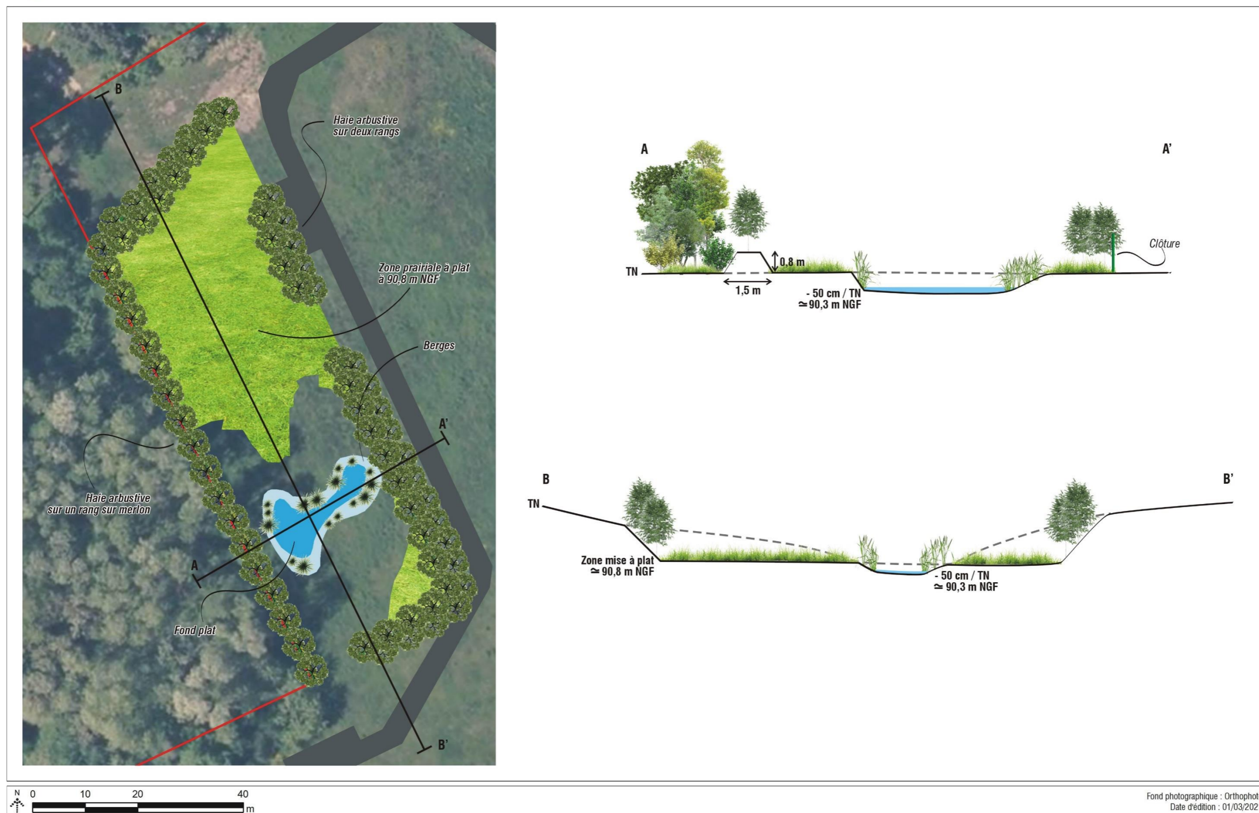
Figure 88 : Plan et coupes de la mesure compensatoire
