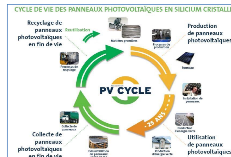
Figure 76 : Cycle de vie des panneaux photovoltaïques en silicium cristallin
